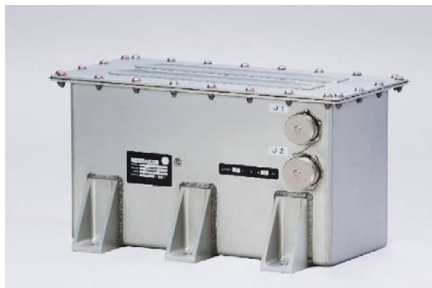
2. H-II A ロケット用リチウムイオン電池
