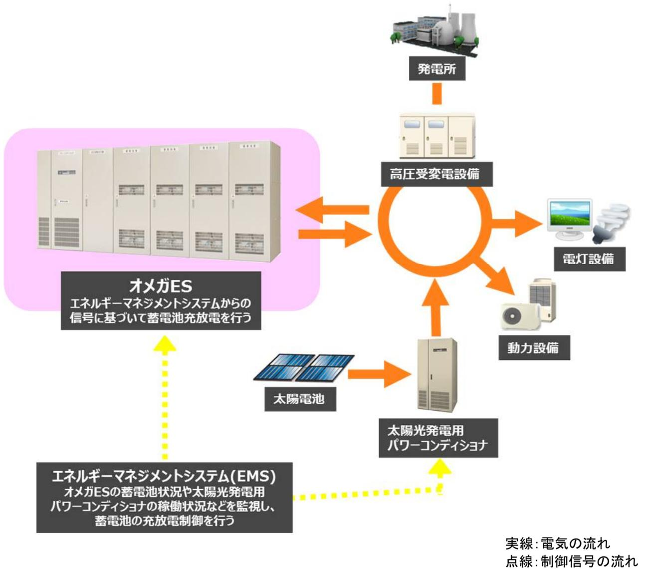
再生可能エネルギーの有効活用を目的としたシステムには、太陽電池やパワーコンディショナなどの設備に加え、エネルギーの流れを制御する EMS が設置される。
