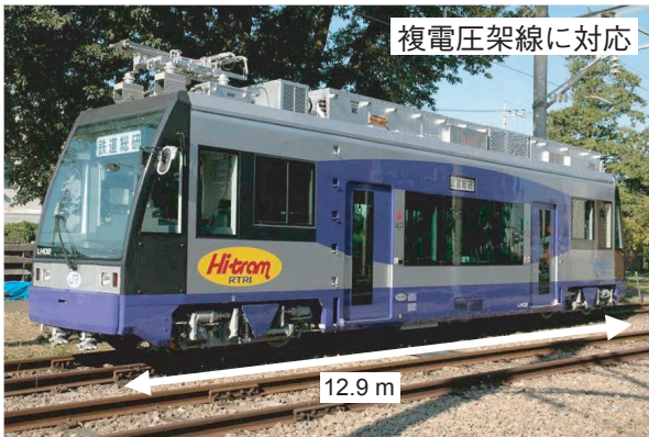
図8 鉄道総研 LH02 「Hi-tram (ハイ！トラム)」 Fig. 8 Contact-wire/battery hybrid LRV 'Hi-tram'.
