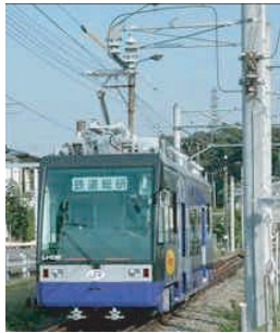
パンタグラフを介して、 停車中LRVのバッテリーを 急速充電
