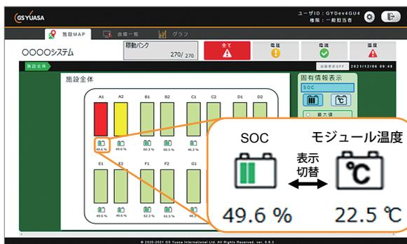
図7 遠隔監視による状態表示
