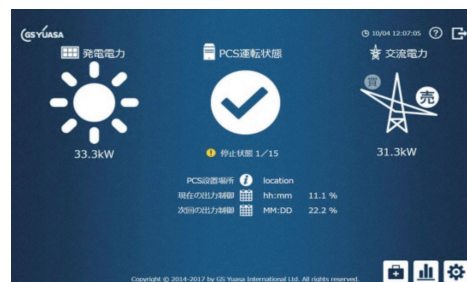
●図 3 PCS 用の通信デバイスの GUI
