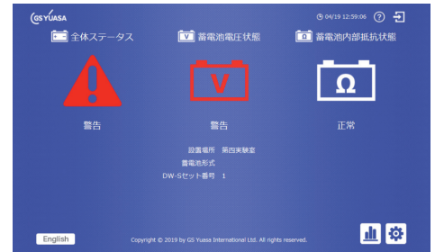
●図 4 鉛蓄電池用の通信デバイスの GUI
