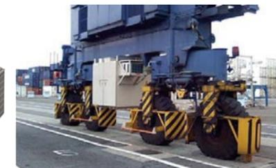
住友重機械エンジニアリングサービス(株)様トランスファークレーン用ハイブリッド電源装置
