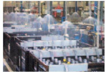
充電時使用冷却水の循環化
