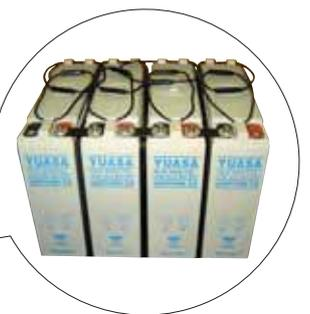
6セル入りの12V形電池なので48V構成であれば電池4個で済み、個々の電池間接続の大幅な低減が可能。
