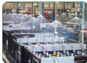
充電時使用冷却水の循環化
