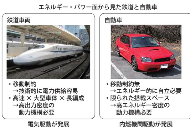
図1 エネルギーとパワー面からみた鉄道の特徴<sup>1</sup>
