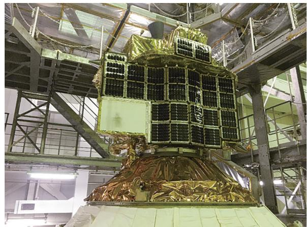
図5 SLIMに搭載されたフィルムアレイシート<sup>14</sup> (©JAXA)
