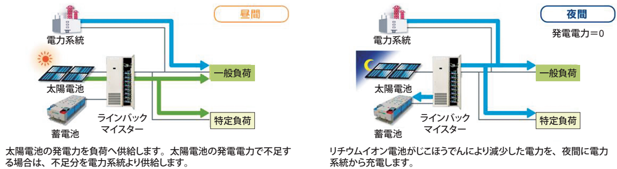
図3 停電対応システムの電力フローイメージ（電力系統健全時） Fig. 3 Power flow image of back-up application system (during normal grid operation).
