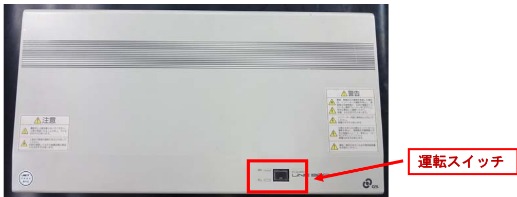
写真3-1 運転スイッチ写真
